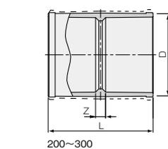
破線はFRP補強品の1.0MPa仕様です。
