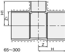
破線はFRP補強品の1.0MPa仕様です。
