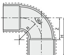
破線はFRP補強品の1.0MPa仕様です。
