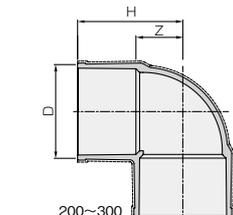
破線はFRP補強品の1.0MPa仕様です。
